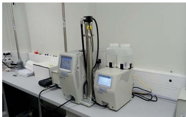
Přístroj na měření početní koncentrace spektra částic v rozsahu 10–800 nm. Foto: M. Bitter
